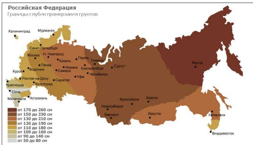
Рисунок 1.8. Границы глубин промерзания грунтов
